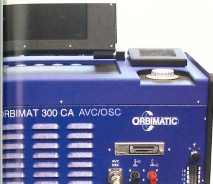
rekt vom Druckminderer in die Kammer des Schweißkopfes geleitet - der unerwünschte Sauerstoff dabei stoßartig ausgespült; die Orbimat®-Stromquelle erkennt und berücksichtigt für den Ablauf des Prozesses automatisch angeschlossene Systemkomponenten, vom geschlos-
