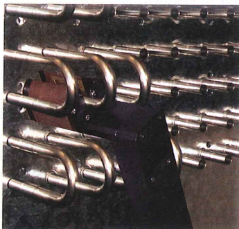
Leichtes Positionieren und Spannen des Schweißkopfes © Orbitalum Tools GmbH
