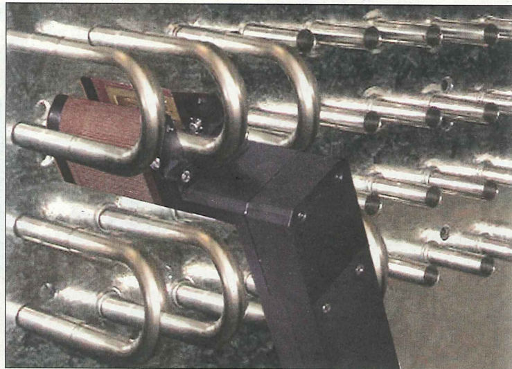
Hoher Kupferpreis – Hersteller steigen auf Edelstahl um: Ein Abstand der Rohre von 24 mm genügt für das spielend leichte Positionieren und Spannen des Orbitalschweißkopfes, so Orbitalum.
