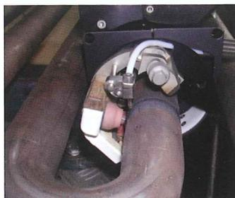
In der kleinsten Zangenausführung kann der Konstrukteur bei einem Rohrbündel mit Rohrdurchmesser 25,4 mm den Abstand zwischen den Rohren auf nur 31,8 mm festlegen
