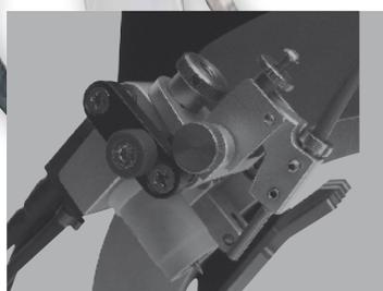
Regolazione precisa della posizione degli elettrodi anche durante il processo di saldatura.
