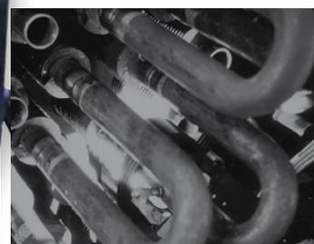
Possano saldare in posizione verticale, orizzontale e inclinata. Posizionamento veloce e semplice sui tubi.
