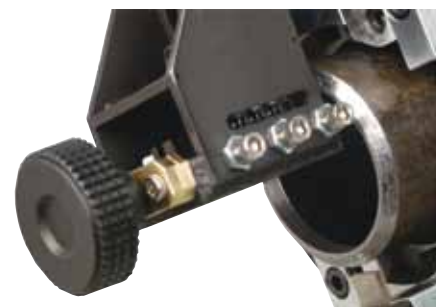
Il sistema lavorazione interna è adatto per tutti i modelli. Montaggio semplice direttamente sulla slitta portautensili.
