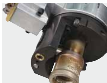
Slitta per taglio radiale di fitting con tasca di saldatura.
