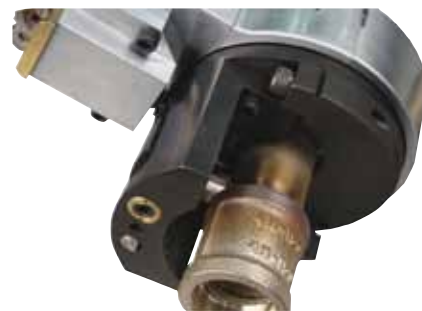
Slitta assiale di rimozione del cordone di saldatura
