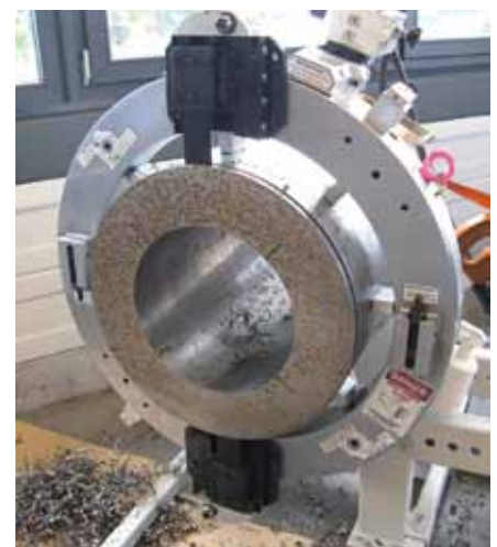
LCSF con gruppo slitta elicoidale
