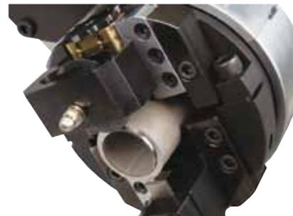
Rollenabschneider-Modul für FME-Schneiden
