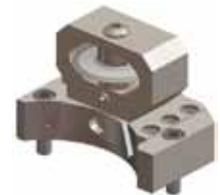
**FME-Werkzeugschlitten.** FME (Foreign Material Exclusion) für spanloses Trennschneiden, um das Einbringen von Spänen zu vermeiden. Ein hochlegierter Rollenabscheider führt den Endschnitt am Rohr aus; dabei werden keine Späne gebildet, die zu einer Verschmutzung des Werkstücks führen können (Vorbearbeitung mit Trennstahl empfohlen).
