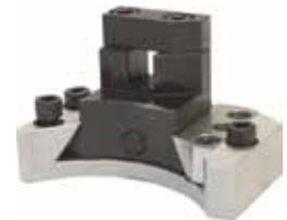
**Werkzeugschlitten zum radialen Trennen von Muffenschweißnähten.** Zur Verwendung mit SDSF zum Trennen von Muffenschweißnähten; der Radialschlitten benötigt weniger Axialabstand. Das Werkzeug wird zum Abtrennen des Schweißmaterials zur Mittellinie des Rohrs (radial) geführt. Auch als vollständiges Kit zum radialen Trennen von Muffenschweißnähten verfügbar.
