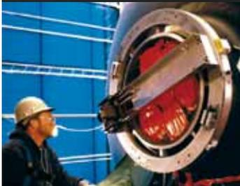
Optionale "Kopiereinheit" für dickwandige Rohre. Fase, Fase mit Doppelwinkel und Tulpennaht.
