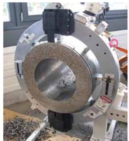
LCSF mit Hochleistungswerkzeugschlitten-Baugruppe
