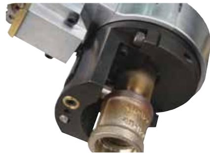
Werkzeugschlitten zum axialen Trennen von Muffenschweißnähten
