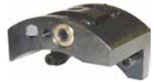
**Werkzeugschlitten zum axialen Trennen von Muffenschweißnähten.** Zur Verwendung mit SDSF zum Trennen von Muffenschweißnähten, der Axialschlitten benötigt weniger Radialabstand. Das Werkzeug wird zum Abtrennen des Schweißmaterials in axiale Richtung entlang des Rohrs geführt. Auch als vollständiges Kit zum axialen Trennen von Muffenschweißnähten verfügbar.
