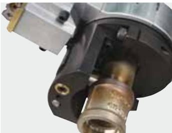
Axialschlitten zum Trennen von Muffenschweißnähten.
