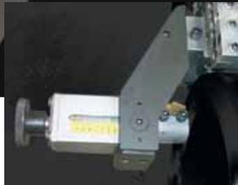
Innenausdrehen für konstante Lippenhöhe, passend für alle Modelle. Sichere Befestigung am Werkzeugschlitten.
