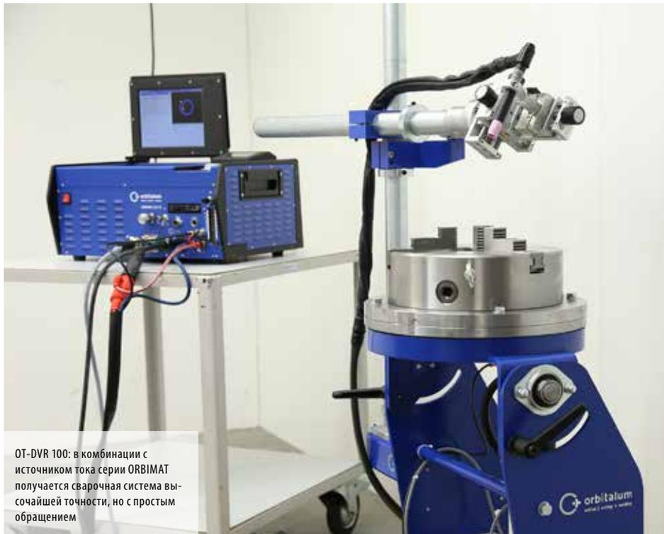
OT-DVR 100: в комбинации с источником тока серии ORBIMAT получается сварочная система высочайшей точности, но с простым обращением
