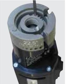
Отрезка электродов (например, с помощью ESG MAX)
