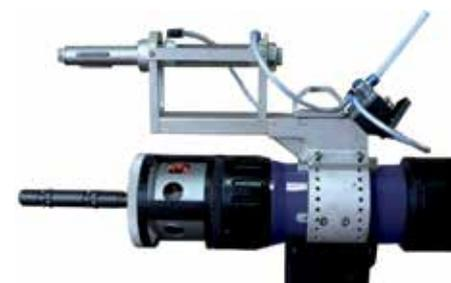
Пневматическое центрирующее устройство
