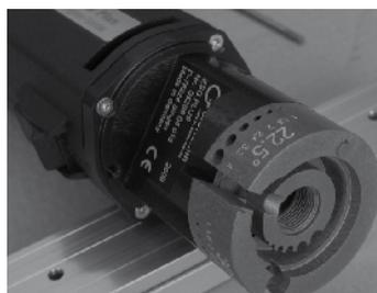
Affilaelettrodi ESG Plus per la lavorazione, l'affilatura e il taglio di elettrodi di saldatura impiegati in saldatrice WIG o TIG.
