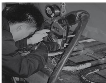
Le teste OP 51 /102 sono disponibili anche con controllo della tensione d'arco (AVC) e oscillazione (OSC).
