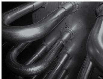
Il sistema di raffreddamento completo su testa, selle e corpo permette ottime performance di saldatura e una lunga durata.
