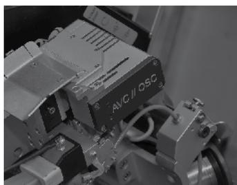
Disponibile anche con controllo della tensione d'arco e oscillazione (AVC/OSC).
