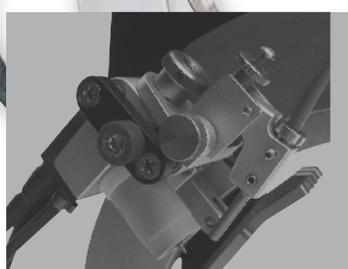
Regolazione precisa della posizione degli elettrodi anche durante il processo di saldatura.
