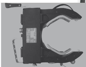
Meccanismo di bloccaggio con ganasce scorrevoli in parallelo. Facile da centrare sul tubo.
