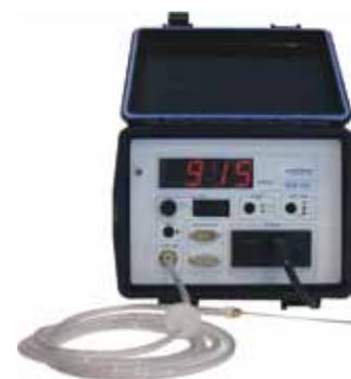
Analizzatore d'ossigeno ORB 1001
