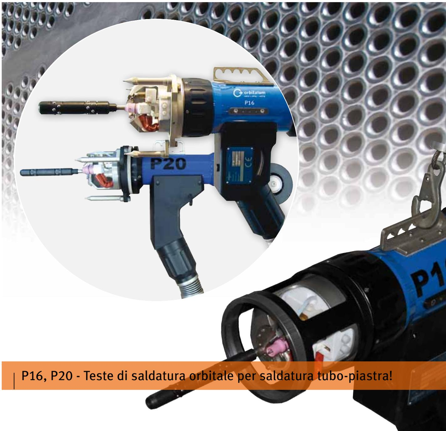
**P16, P20 - Teste di saldatura orbitale per saldatura tubo-piastra!**
