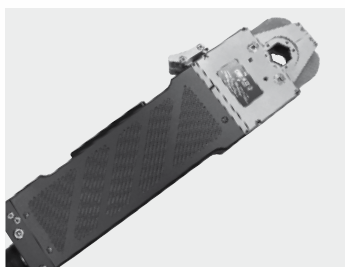
ORBIWELD 19 型 密封式轨道焊接头适用于直径在3 - 19.05毫米 (0.118 - 0.750英寸) 范围内的管道。具有格外狭窄的构造形状而且由于有水冷系统能承受较高的负载。
