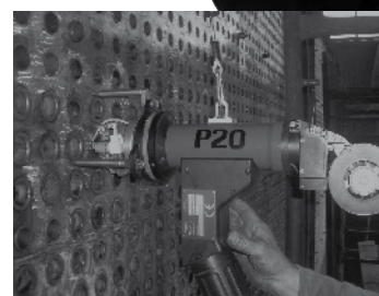
将功能多样化发展到极致，且操作简便。借助可更换的中心芯盒，实现精准对中。
