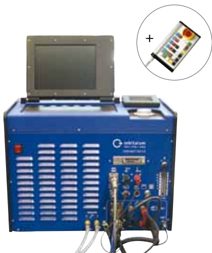
带有外部远程操作的ORBIMAT 300 CA AVC/OSC
