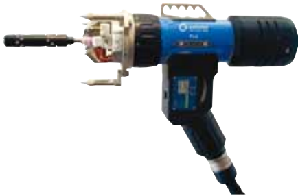
P16 型管板焊接头
