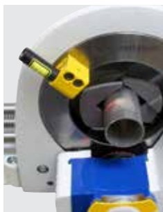
Встроенный лазерный указатель для маркировки мест обрезки на трубе
