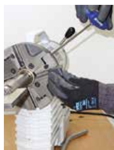
Система быстрого зажима инструмента QTC® (Quick-Tool-Change)
