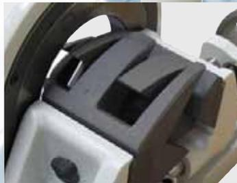
Serrage sans déformation des tubes à parois fines
