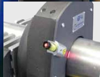
**Laser linéaire intégré** pour matérialiser le point de coupe sur le tube
