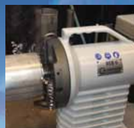
Kompaktes Design für eine präzise und reproduzierbare Schweißnahtvorbereitung.
