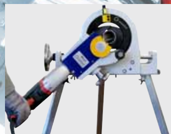
Trennen dünnwandiger Edelstahlrohre und Rohrbögen
