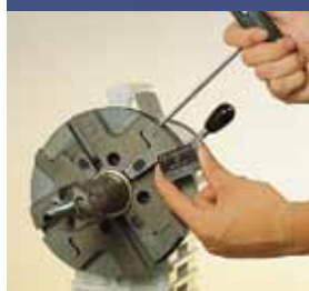
Werkzeug-Schnellspannsystem QTC® (Quick-Tool-Change).
