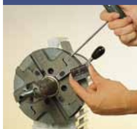
刀具快速夹紧系统 QTC® (Quick-Tool-Change).
