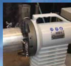
机器小巧轻便·可将管道精确的加工成理想的切割面
