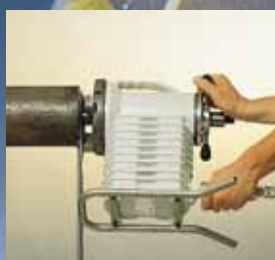
通过内置把手可灵活的将机器固定在管子上
